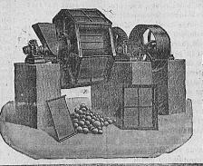
MACCHINE PER FRANTUMARE E POLVERIZAR E specialmente MOLINI A PALLE a riempimento e vu ospecialmente mollist a Pallis a riempimento e vi o-tamento continao per polverizzare cemento, scorie, quorzito, spathfluor, argilla secca e cotta, pietre cal-caree, gesso, zolfo minerali, ecc., Schiacciapie tre, Molini a cilindri, Molini e macini verticali, Molini a vite frantumatrice, Desintegratori, ecc.
