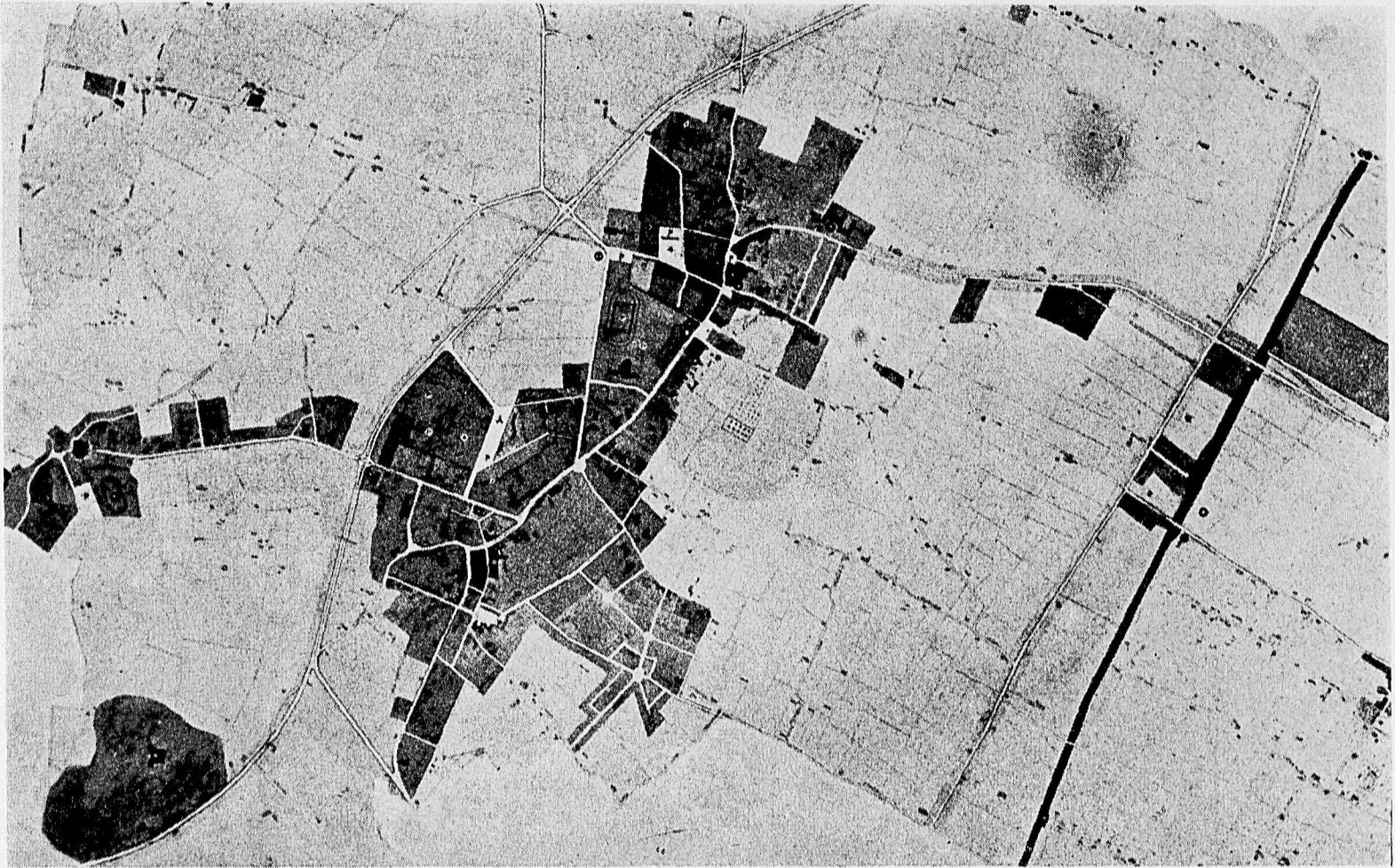
« Concorso di idee » per il piano regolatore di Abano. Progetto Battaliard-Maretto-Menegazzo-Scimemi. Netta separazione di Abano-paese dall'« Oasi Termale »; grande strada di scorrimento ad ovest, in continuazione della progettata direttissima da Padova.
