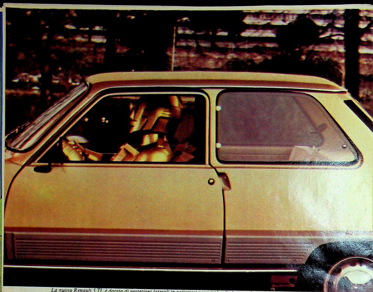
La nuova Renault 5 TL è dotata di protezioni laterali in poliestere semirigido, di elegante design e collaudata robustezza.
